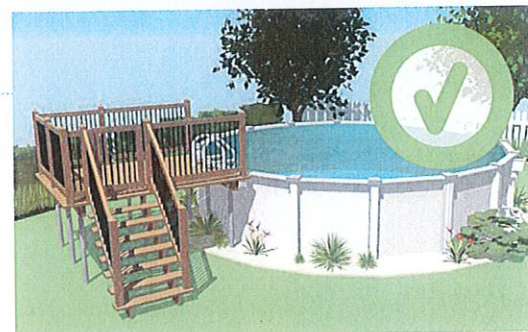
Exemple de plateforme dont l'accès est protégé par une enceinte.
