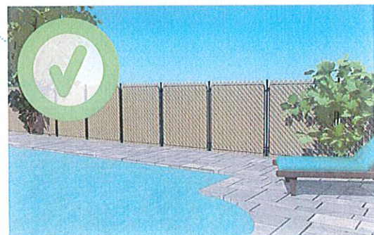
Exemple de clôture en mailles de chaîne lattée.
